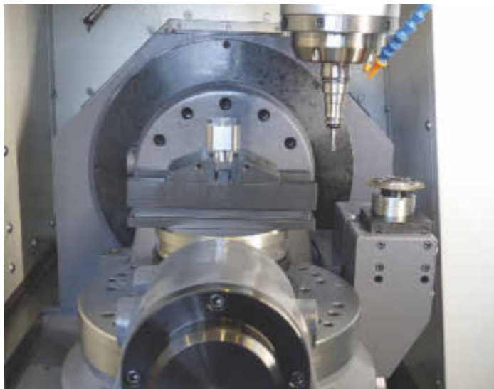
Der Schleifstift sitzt im Rotationszentrum der Spindel und führt die Oszillationsbewegung durch. Bild: Fehlmann
