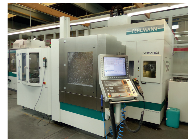
Bild 4: Mit dem 5-Achs-Bearbeitungszentrum VERSA 825 von Fehlmann werden sowohl Positiv- wie Negativ-Modelle mit Hinterfräsungen und seitlichen Anstellungen aus Aluminiumblöcken gefräst
