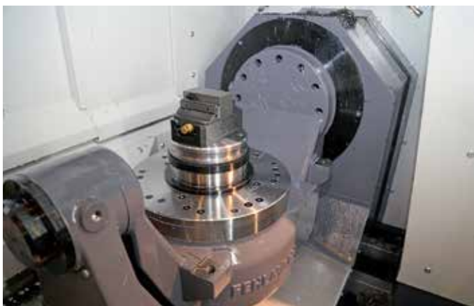
Inneneinblick: die neue Versa 645 zur hochdynamischen 5-Achs-Bearbeitung ist mit einem Rund-Schwenktisch ähnlich der Versa 825 ausgestattet.
